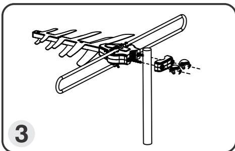
3) Para fixar a antena, basta abrir o grampo em V e fechar no mastro ou suporte. Aperte os parafusos, variando entre um lado e outro, para que o grampo fique centralizado com o mastro.
