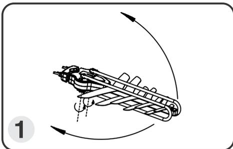
1) A antena já está montada. Basta abrir os parafusos borboleta e colocar os dipolos para trás até ficar na perpendicular.
