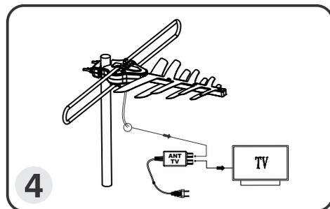
4) Ligue o cabo na parte inferior da antena e ligue no *booster* autovolt na parte onde está escrito ANT. Ligue o cabo coaxial do amplificador, onde está escrito TV até sua TV e ligue o amplificador na tomada.
